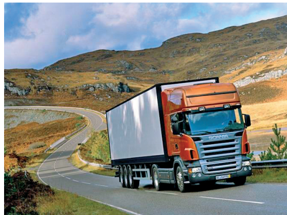
Med digitala kartor och GPS förbereds lastbilens motor inför en backe. Lastbilens bränsleförbrukning kan därmed minskas. (Foto: Scania)
