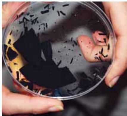
Elektrodmaterialiet till algbatteriet. Det är en komposit som består av cellulosa och ett ledande material.
