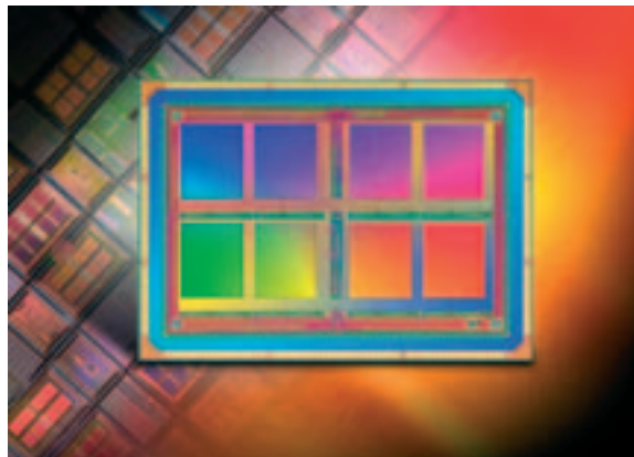
Ett magnetiskt RAM-minne (MRAM) – en variant på vanligt RAM-minne. MRAM är baserat på spintronik och kan komma att ersätta flera av dagens olika minnestyper.
