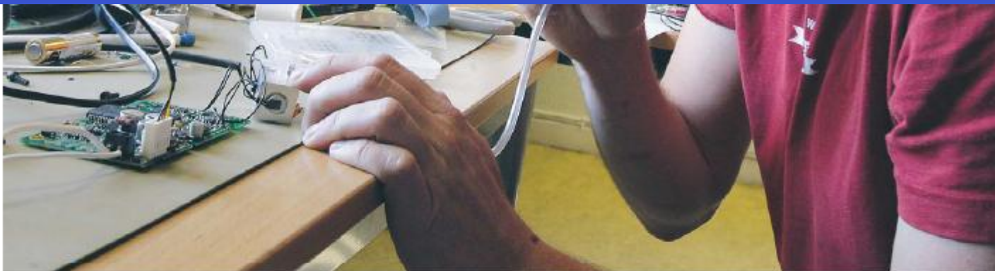
Forskaren Henrik Rödjegård blåser in koldioxid med sin utandningsluft i en prototyp av den nya koldioxidmätaren.
