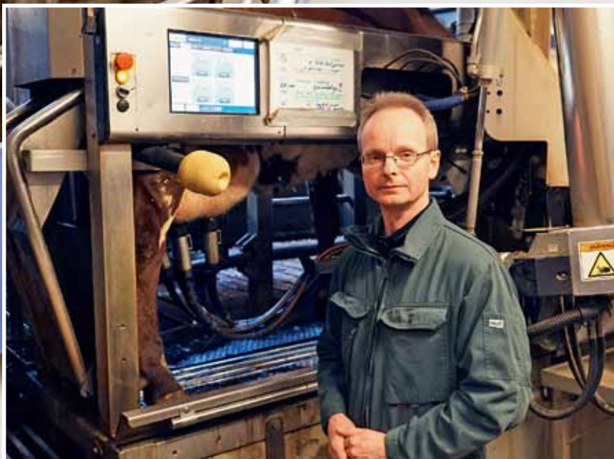
System för automatiserad mjölkning, ett så kallat VMS – Voluntary Milking System.
